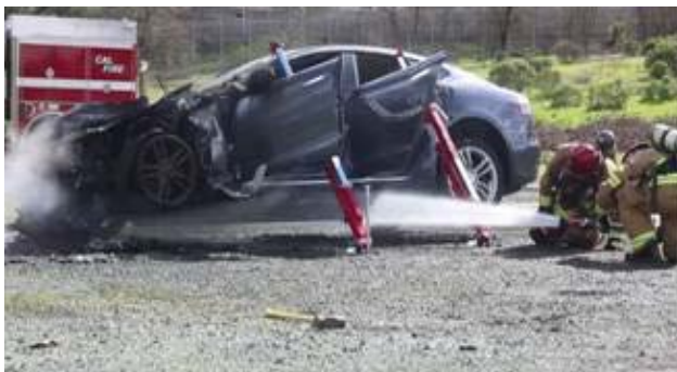
а – охлаждение силовой батареи
