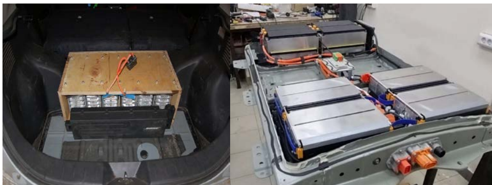
Рис. 2 – Слева дополнительные батареи в багажнике, справа замена на более энергоемкие батареи [3]
