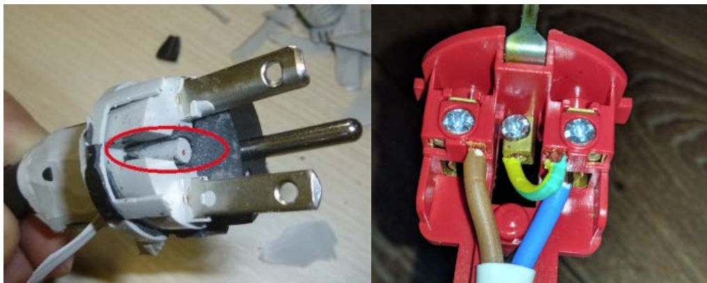
Рис. 4 – Слева разобранный японский вилок зарядного устройства, справа подключение заземления к нулевому проводнику [3]
