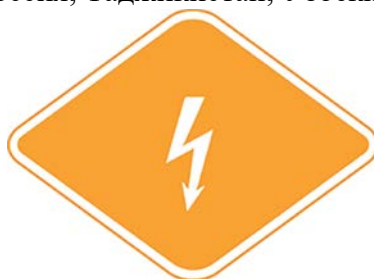
Рисунок 5 – Идентификационная наклейка для xEV
