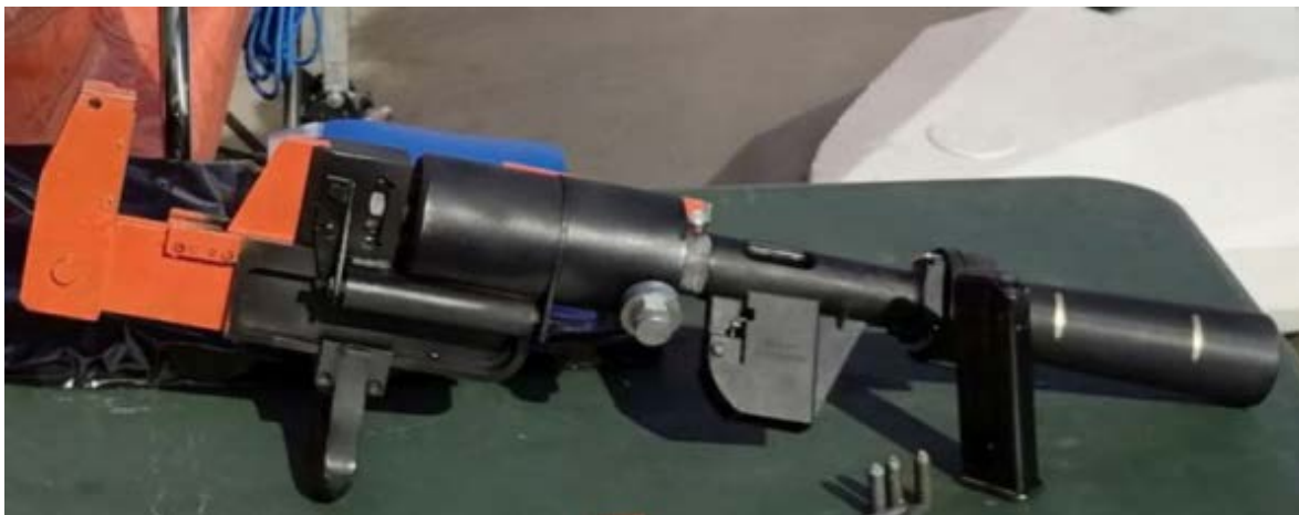
Рис. 6 - Действующий опытный макет аварийно-спасательного инструмента с пироприводом
