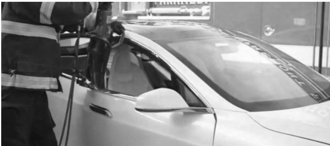
Рис. 1 – Процесс демонтажа дверной карты электромобиля
