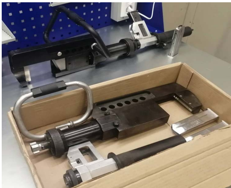
Рис. 7 - Модель опытного образца аварийно-спасательного инструмента с пироприводом
