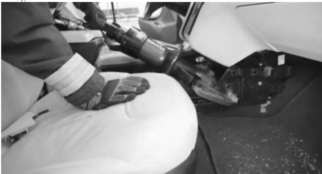
Рис. 3 – Процесс резки крепления приборной панели в салоне электромобиля
