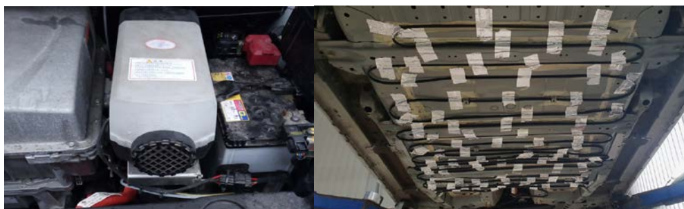
Рис. 3 – Слева автономный отопитель, справа обогрев высоковольтной батареи с помощью греющего кабеля [3]
