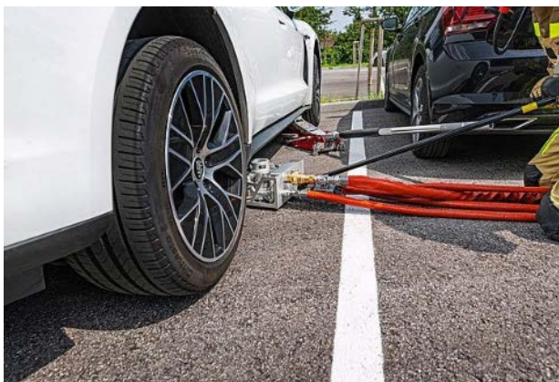
Рис. 2 – Использование пробивного ствола при пожаротушении электромобилей
