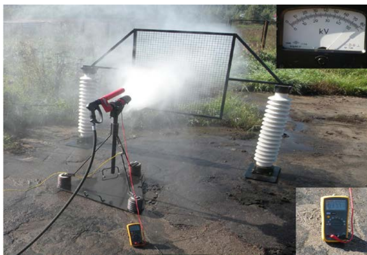
Рис. 2 – Испытание УПТВ 50/120 на ток утечки по струе огнетушащего вещества при напряжении 50 кВ.
