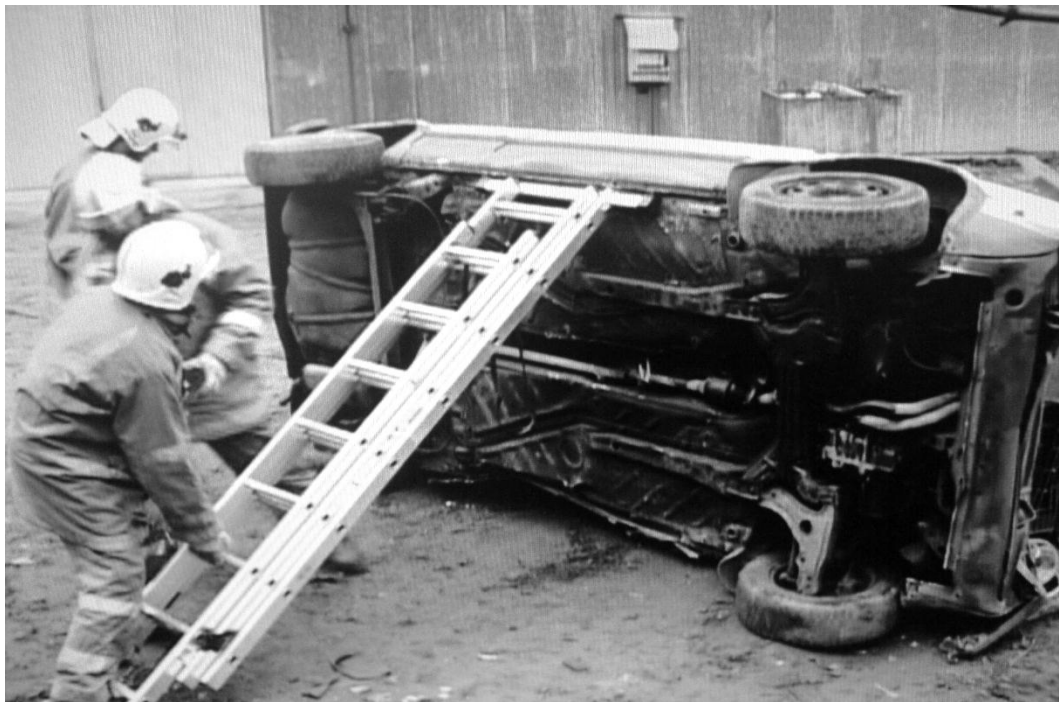
Рис. 6. Стабилизация ТС, лежащего на боку в результате ДТП.
