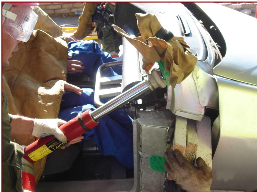
Рис. 8. Установка защиты на острые края и кромки.
